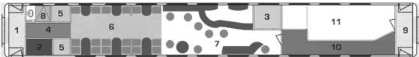
Рис. 96. Схема вагона-ресторану підвищеної комфортності 1 – тамбур гальмового кінця вагона, 2 – котельне відділення, 3 – службове відділення, 4 – малий коридор, 5 – холодильна шафа, 6 – салон ресторану, 7 – салон бару, 8 – умивальне відділення, 9 – тамбур негальмового кінця вагона, 10 – бічний коридор, 11 – кухня
